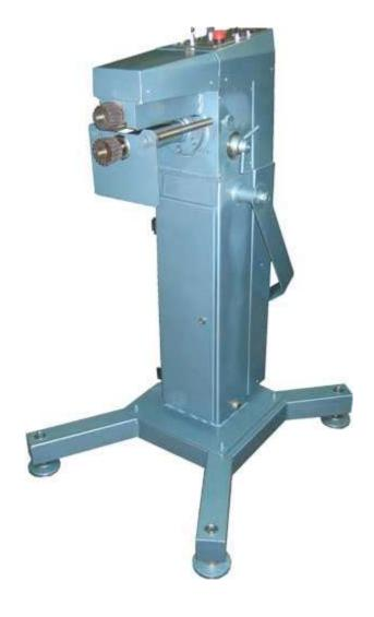
**Зиговочный станок** предназначен для работы с тонколистовым металлом и выполняет следующие операции: отбортовку кромки под бандаж, отрезку края обечайки, вырезание сегментов отводов, формирование кольцевого зига, гофрирование торца, отбортовку края сегментов, также при изготовлении различных вентиляционных изделий.
