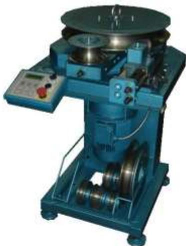
**Трубогибочный станок** предназначен для **гибки труб** из черных, цветных, нержавеющей металлов, оцинкованных и без покрытия, а также для **гибки профильных труб** и сортового проката методом обкатки в холодном состоянии.
