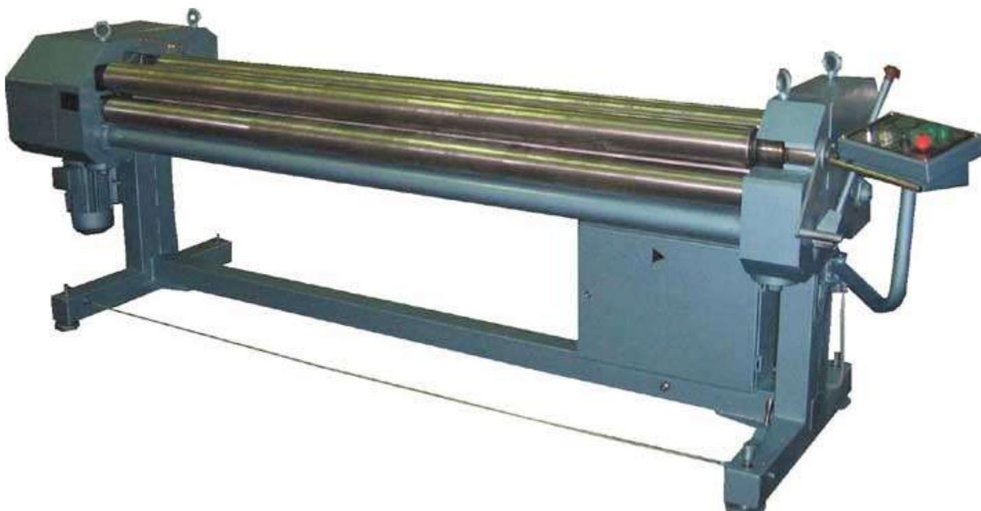
Вальцы листогибочные являются универсальной машиной ротационного типа, предназначенной для гибки листа в холодном состоянии. Предназначены для гибки-вальцевания заготовок из листового проката черных, цветных металлов и сплавов, с пределом текучести не более 2500 кг/см.
